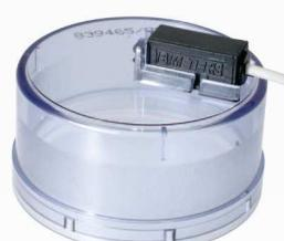
Il maggior numero di tentativi di frode verso i dispositivi con uscita ad impulsi viene effettuato tramite l'uso di magneti esterni, tentando così di alterare il corretto funzionamento degli emettitori di impulsi. I nostri emettitori di impulsi possono essere dotati di un ulteriore contatto REED, che creerà un segnale di allarme appena un magnete esterno verrà avvicinato al contatore d'acqua.
